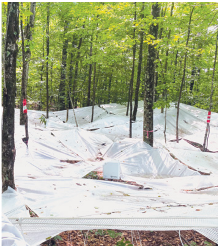
Figure 1 - Photographies d'une parcelle du traitement d'exclusion de précipitations à Kenauk Nature. À gauche, on voit une parcelle comprenant les baches après un événement de précipitations en été. À droite, la photographie montre les installations pendant une visite lors de l'hiver.
